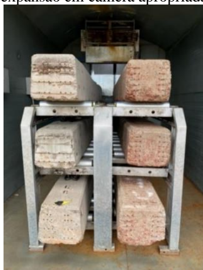
Figura 4: - Dormentes armazenados durante expansão em câmara apropriada
