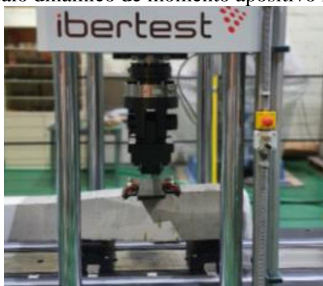
Figura 12: – Ensaio dinâmico de momento apositivo no apoio do trilho
