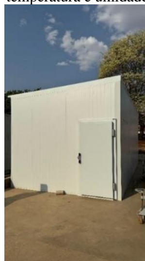
Figura 5: – Câmara com controle de temperatura e umidade
