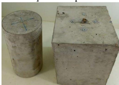
Figura 6: - Corpo de prova com pino para a medição das expansões
